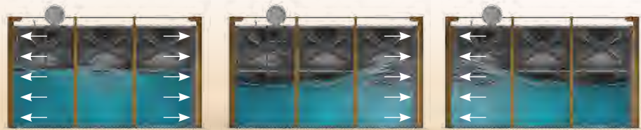
Deprem öncesi statik yük altındaki depo
