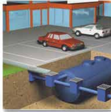
Yeraltı Suyu Biriktirme Tankları
