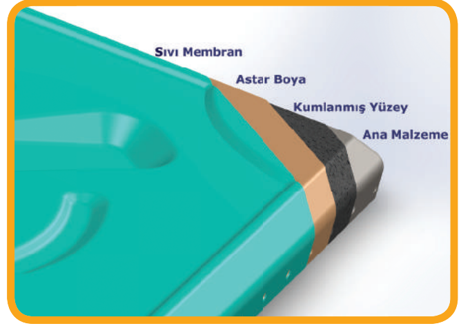
Sıvı Membran Kaplama Prosedürü
